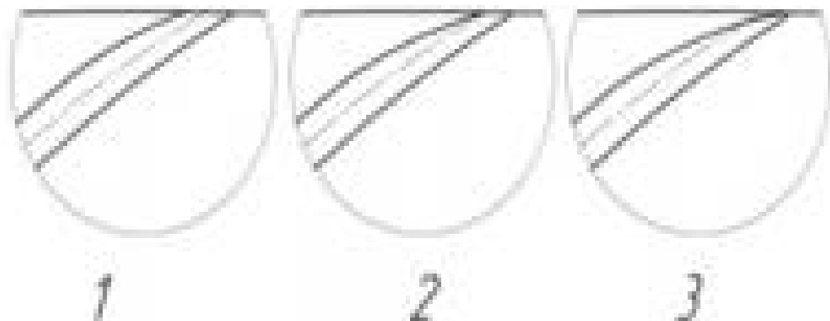
Рис.1.4 Варианты исполнения выходной кромки лопатки рабочего колеса
