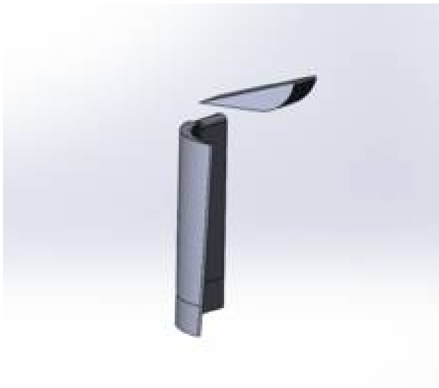
Рис 3.1 Модель рабочий лопатки и соплового аппарата
