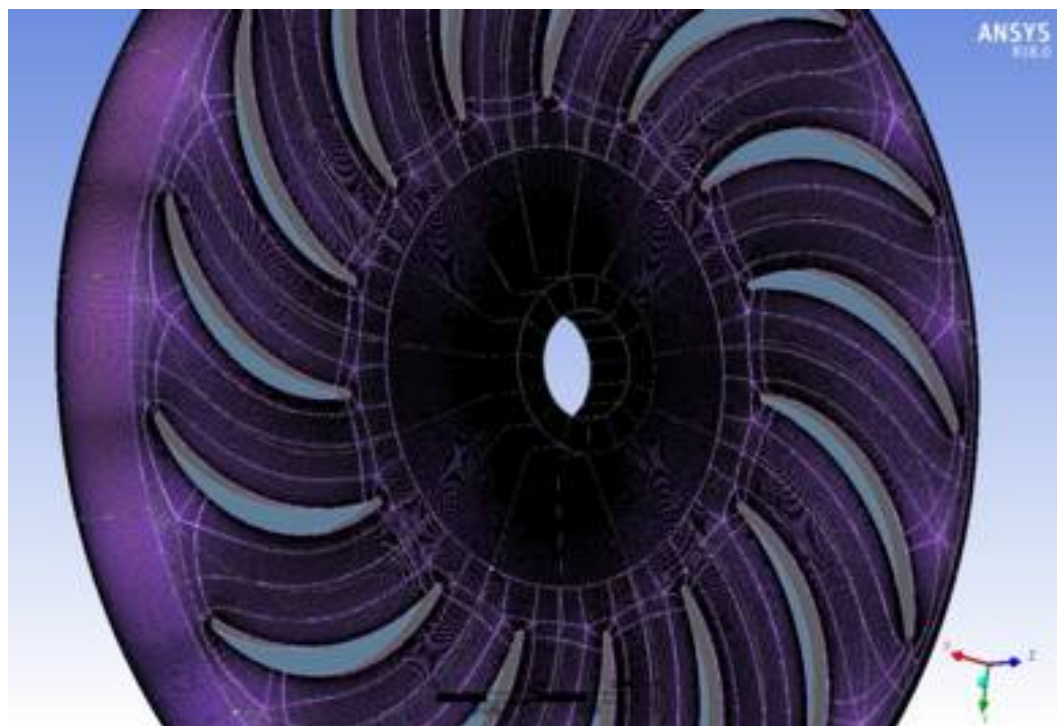
Рис. 2.4. Расчетная сетка ОНА
