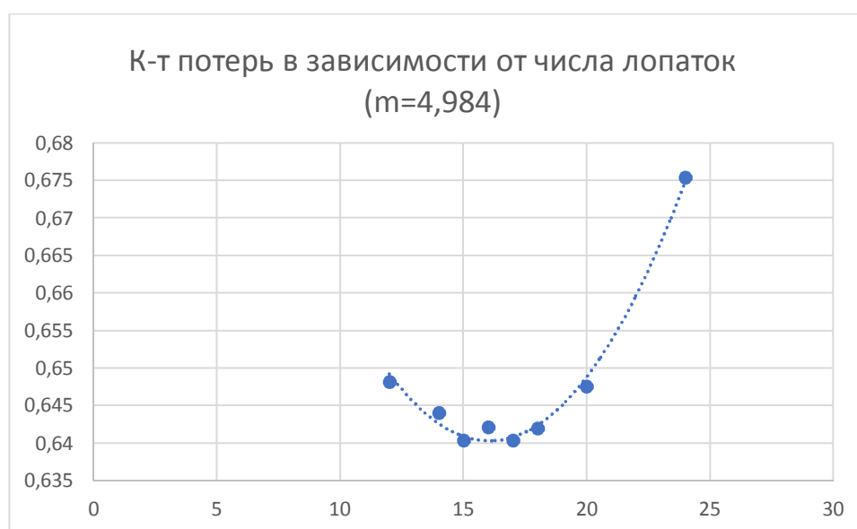
Рис. 3.3. Зависимость к-та потерь от числа лопаток
