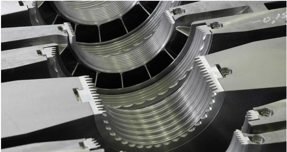
Рисунок 4. Обоймы лабиринтного уплотнения ЦСД с рядом лунок
