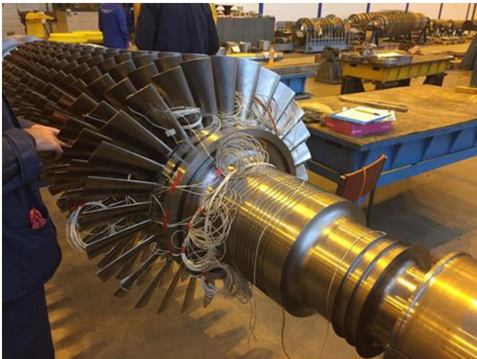
Рисунок 7. Подготовка ротора ОК-2100 к тензометрированию
