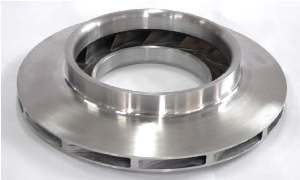
Рисунок 5. Рабочее колесо ЦВД сваренное через прорези в покрывающем диске
