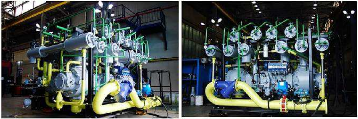
Рисунок 2. Углекислотное оборудование на базе компрессора 4УМ2,5-15/76
