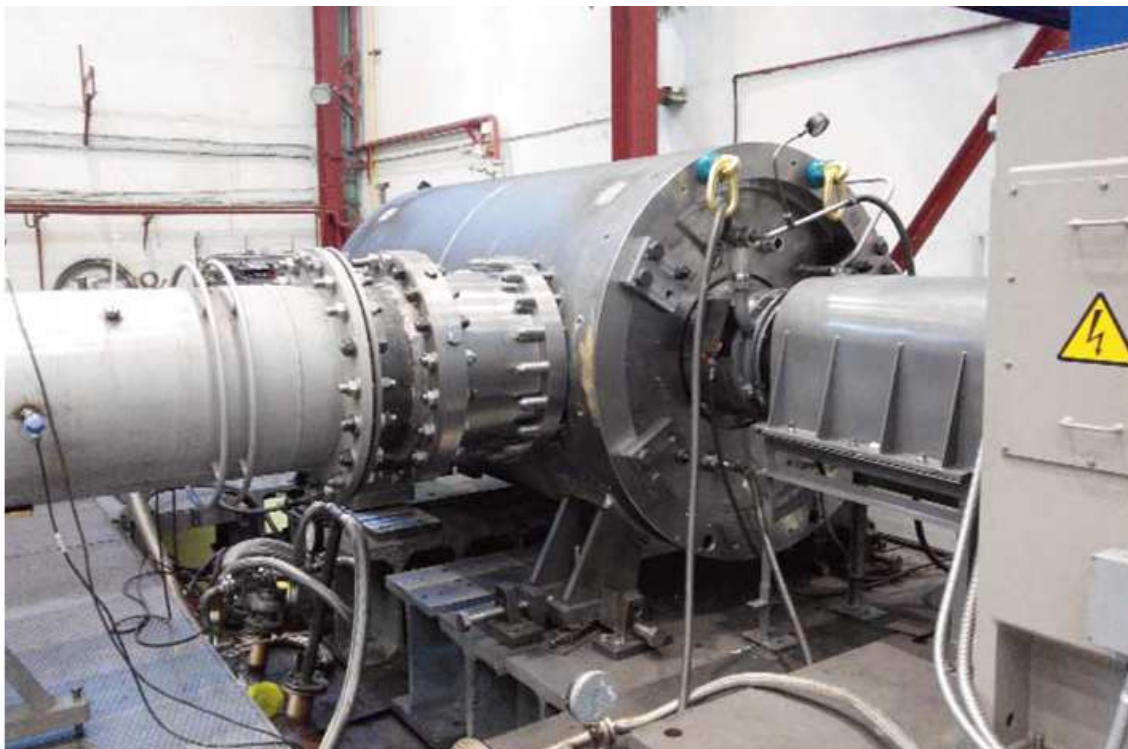
Рисунок 4. Унифицированный ЦБК мощностью 16 МВт для объектов добычи
