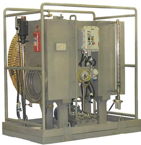
Рисунок 1. Установка УПР-ТПГ стационарная, для промывки ЦБК
