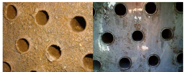
Рисунок 4. Трубный пучок АВОг до и после промывки раствором НТ-310.
