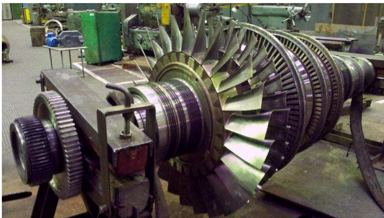
Рисунок 4. Модернизированный ротор ЧНД паровой турбины
