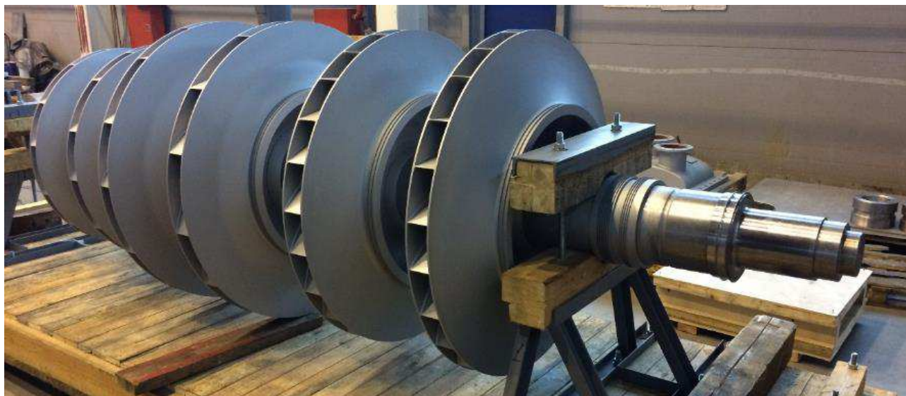
Рисунок 6. Модернизированный ротор компрессора типа K1500-62-2
