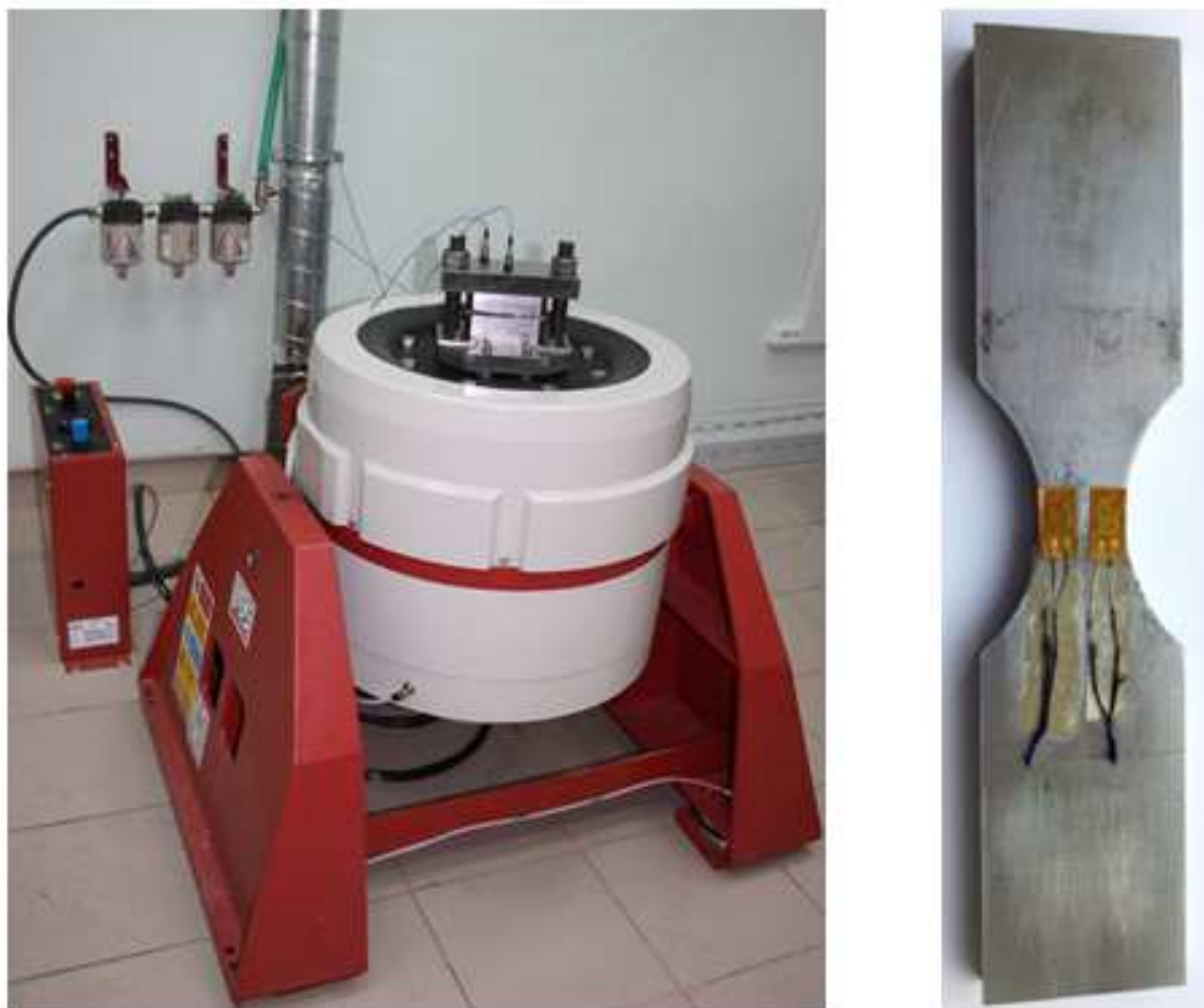
Рисунок 3. Испытательный стенд и образец для усталостных испытаний.
