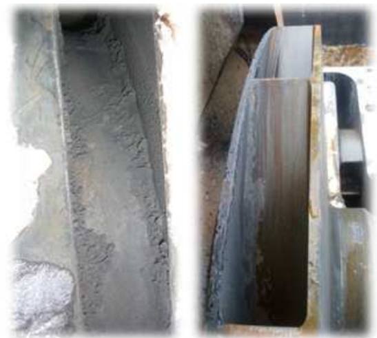
Рисунок 2. Рабочее колесо ЦБК до и после промывки
