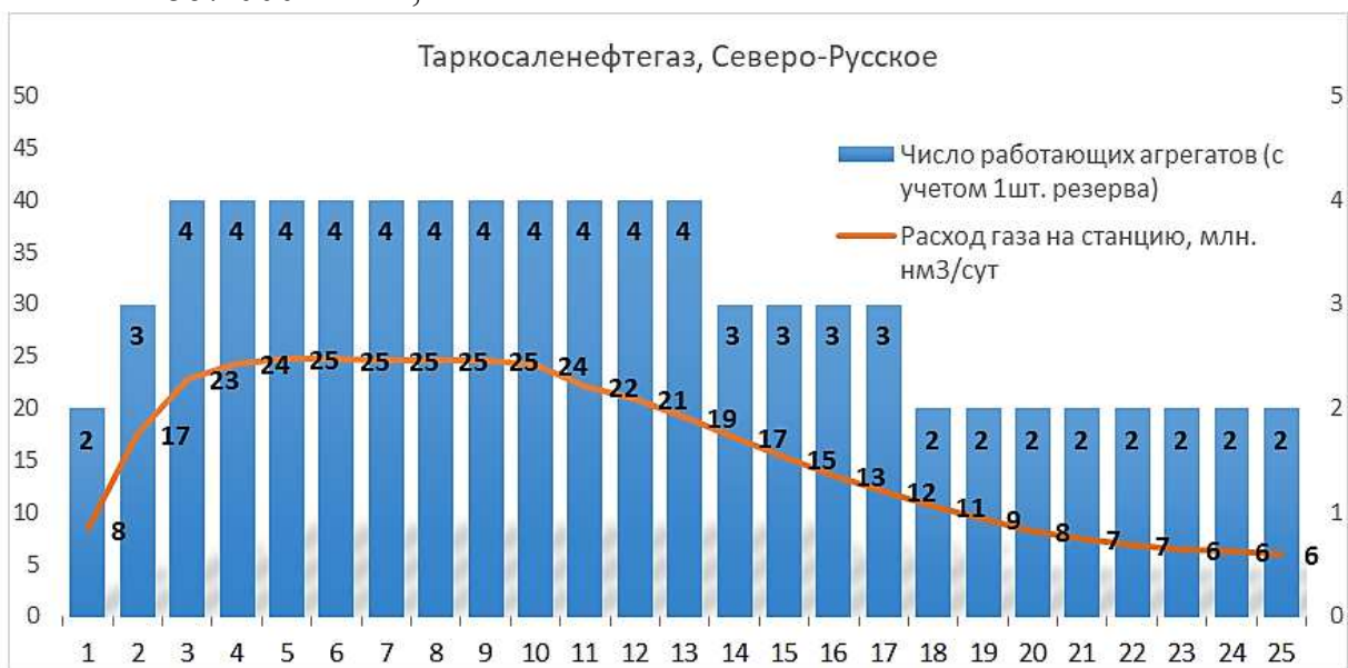
Рисунок 1. Эксплуатация дожимной компрессорной станции Северо-Русского месторождения, Таркосаленефтегаз, ОАО «НОВАТЭК».
