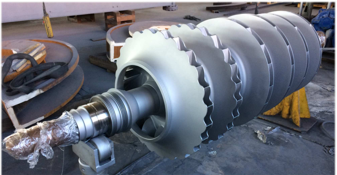
Рисунок 5. Модернизированный ротор компрессора типа К500-61-1
