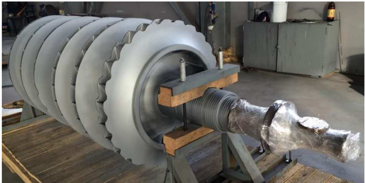
Рисунок 1. Модернизированный ротор ЦНД (компрессор типа 2MCL1006+2MCL456)
