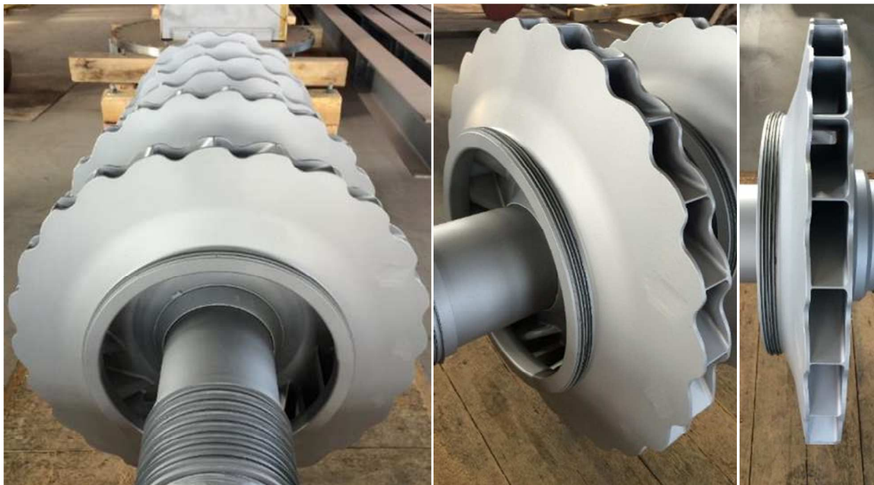
Рисунок 2. Модернизированный ротор ЦВД (компрессор типа К1290-121-1)
