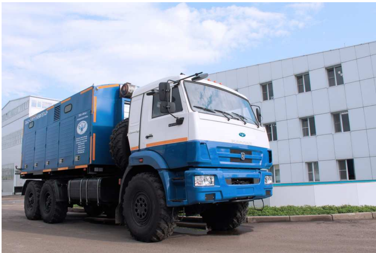
Рисунок 1. Новая передвижная азотная компрессорная станция ТГА-10/251
