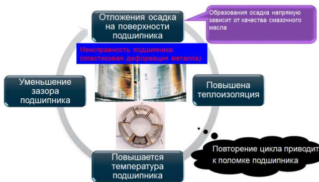
Рисунок 9. Процесс повреждения подшипника из-за образования осадка
