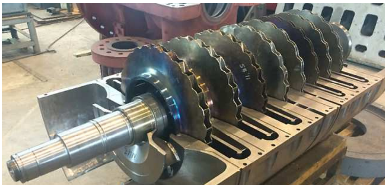
Рисунок 3. Модернизированный ротор и пакет ЦНД
