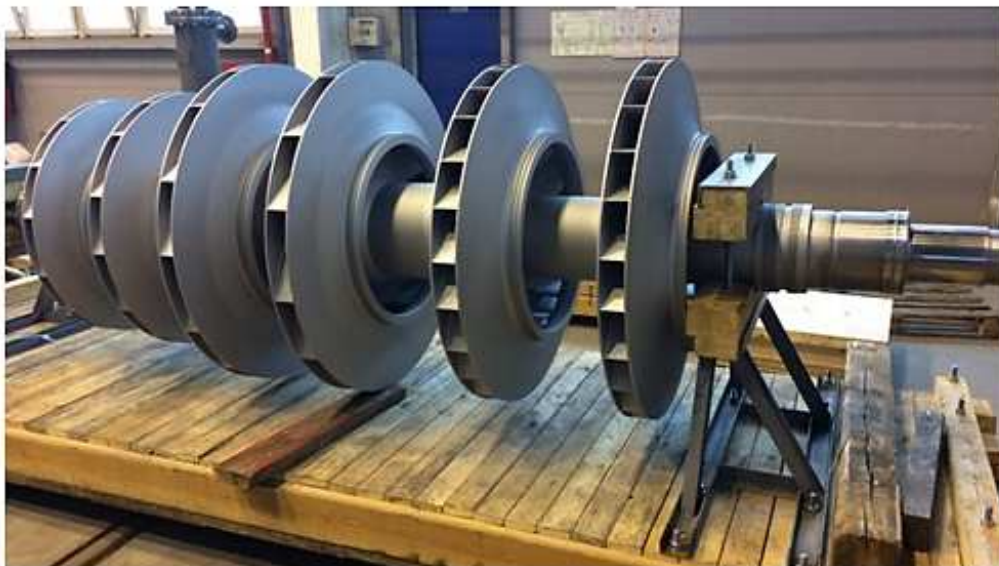
Рисунок 5. Ротор модернизированного компрессора
