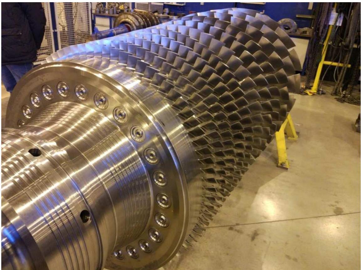
Рисунок 9. Локализованный ротор газогенератора MS5002E
