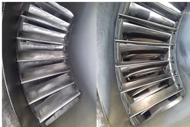
Рисунок 3. Лопатки ВНА и рабочие ло- патки 1-ой ступени ГВТ до и после про- мывки раствором НТ-110.
